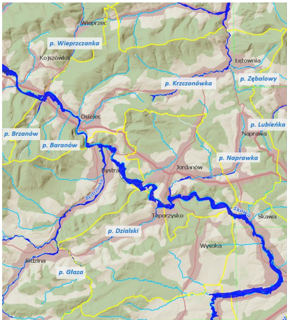
Mapa 2. Obszar szczególnego zagrożenia powodzią przy średnim prawdopodobieństwie wystąpienia powodzi (Q=1%, tzw. raz na 100 lat) – w granicach granatowych linii
